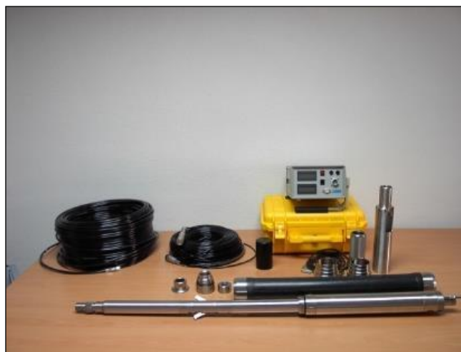
Figura 4. Equipo empleado para la realización de ensayos presiométricos
