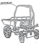
NOTA- ESTOS VEHICULOS QUE NO TENGAN CABINAS CUBIERTAS PARA EL CONDUCTOR, DEBERAN SER PROVISTOS DE PORTICOS DE SEGURIDAD PARA CASO DE VUELOS. (ART. 124 O.S.N.L.)
