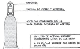
UN LITRO DE ACETONA ABSORBE VEINTICUATRO LITROS DE ACETILENO A 15 Kg/cm<sup>2</sup> ABSORBE 360 LITROS DE DICHO GAS
