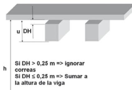
**Figura A.8 – Distancia entre techo y viga.**
