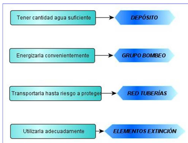
Figura 27 - Esquema de elementos de extinción
