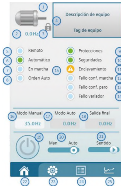
Ilustración 4. Ejemplo de pantalla para diálogo del motor y selector manual-automático
