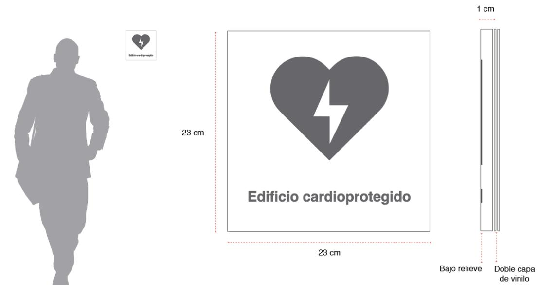
Se instalará anclando directamente a la valla mediante medios mecánicos una trasera de aluminio de 230 mm x 230 mm y 2 mm de espesor, lacada (mate) en blanco, adherida a la placa de metacrilato mediante cinta de doble cara y adhesivo neutro de alta tracción.
