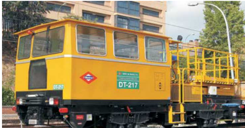
Figura 7. DT-217. Dresina de conservación de Obra civil.
