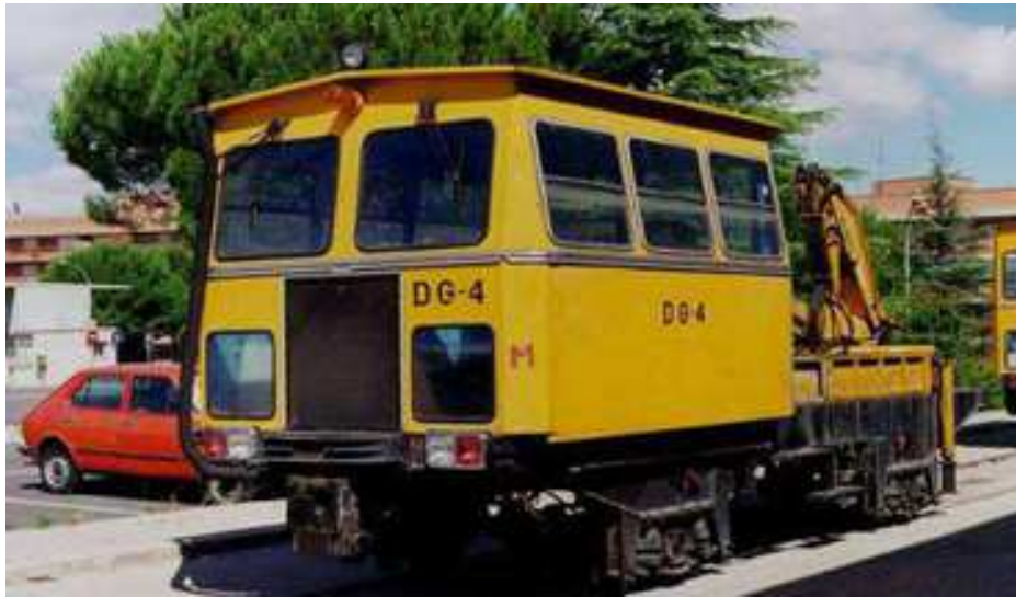
Figura 11. DG-4. Dresina de ejes con plataforma de carga y grúa.
