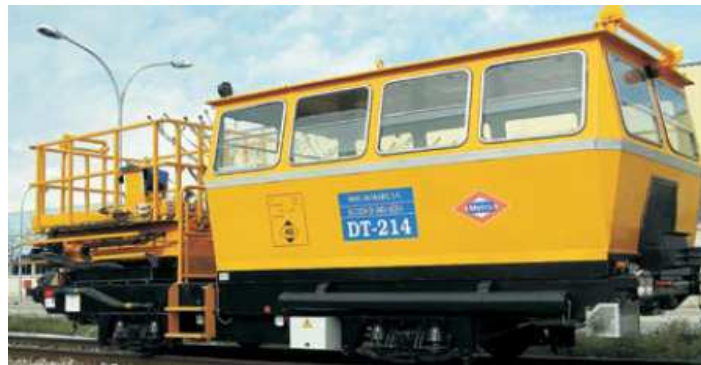
Figura 6. DT-214. Dresina torre.
