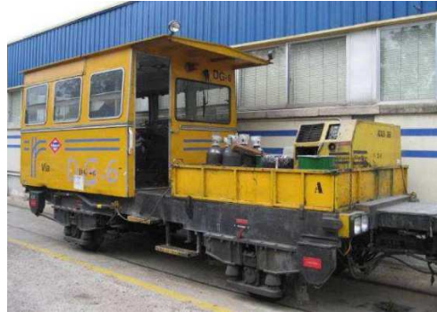
Figura 13. DG-6. Dresina de ejes con plataforma de carga y grúa.
