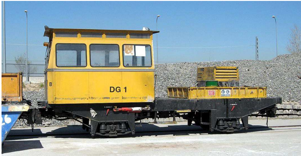
Figura 9. DG-1. Dresina de ejes con plataforma de carga y grúa.
