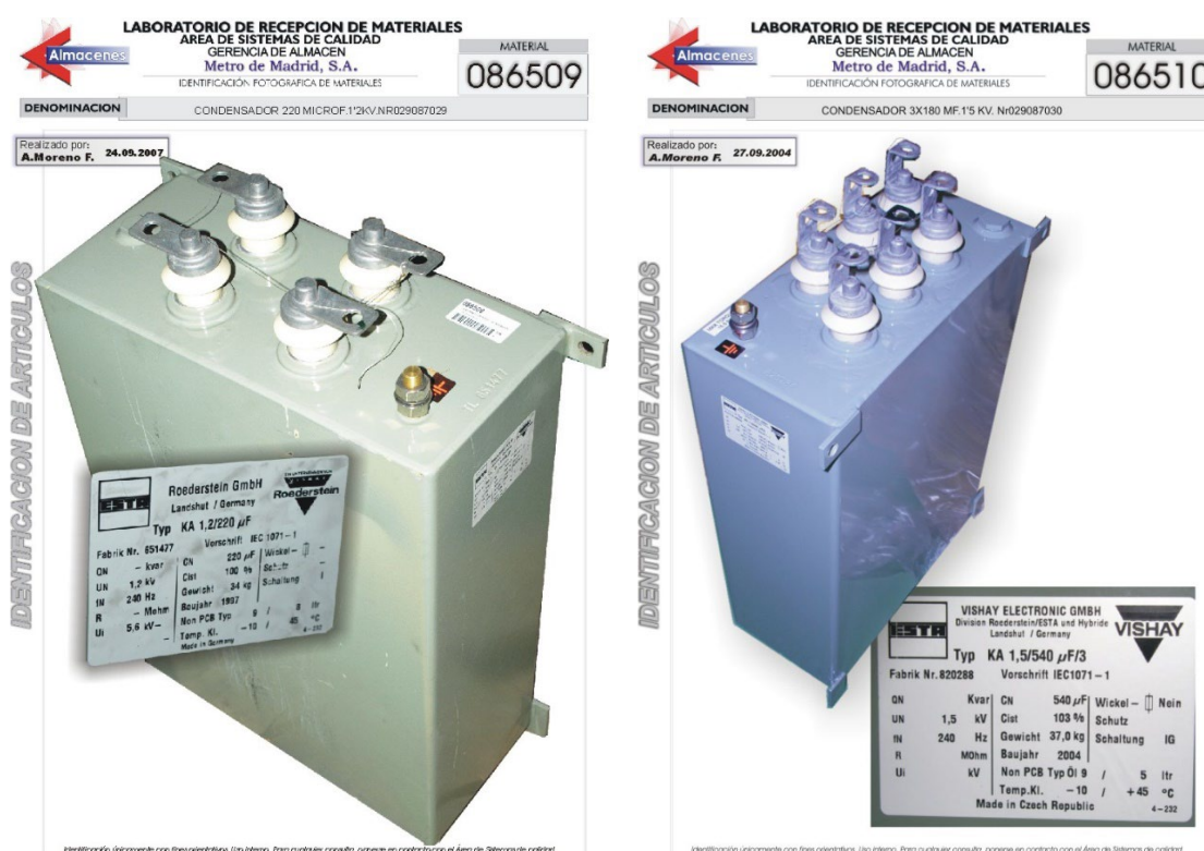
Figura 2. Condensadores C1 (220 \mu F / 1,2 kV) y C2, C3 (3 x 180 \mu F / 1,5kV)
