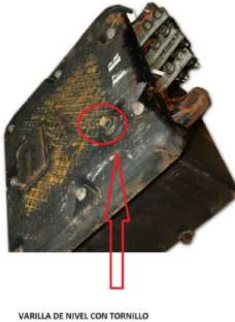
Ilustración 3 Junta inductiva de Alston
