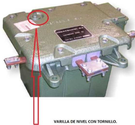
Ilustración 2 Junta inductiva de Siemens
