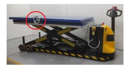
Las mesas dispondrán de alojamientos para cáncamos que permitan la posibilidad de ser transportados mediante elementos de elevación y ser depositados en camiones para ser desplazadas a otros depósitos.
