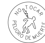
Señal de peligro de muerte
