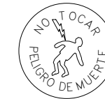
Señal de peligro de muerte
