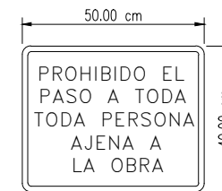
Cartel indicativo de riesgo
